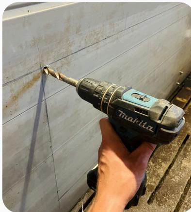
2. Bohren Sie in den Ecken des markierten Ausschnitts Löcher mit einem Durchmesser von etwa 12 mm.
